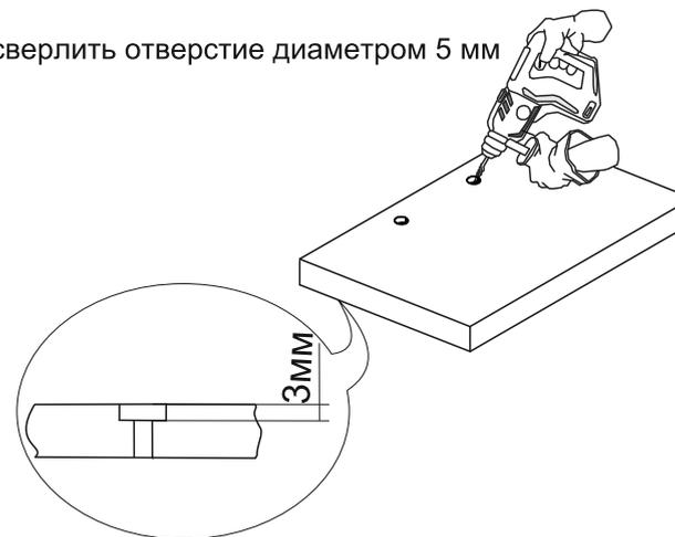
В зависимости от толщины двери, при необходимости, на двери со стороны наколок досверлить отверстие диаметром 8 мм на глубину 3 мм. (потай)
